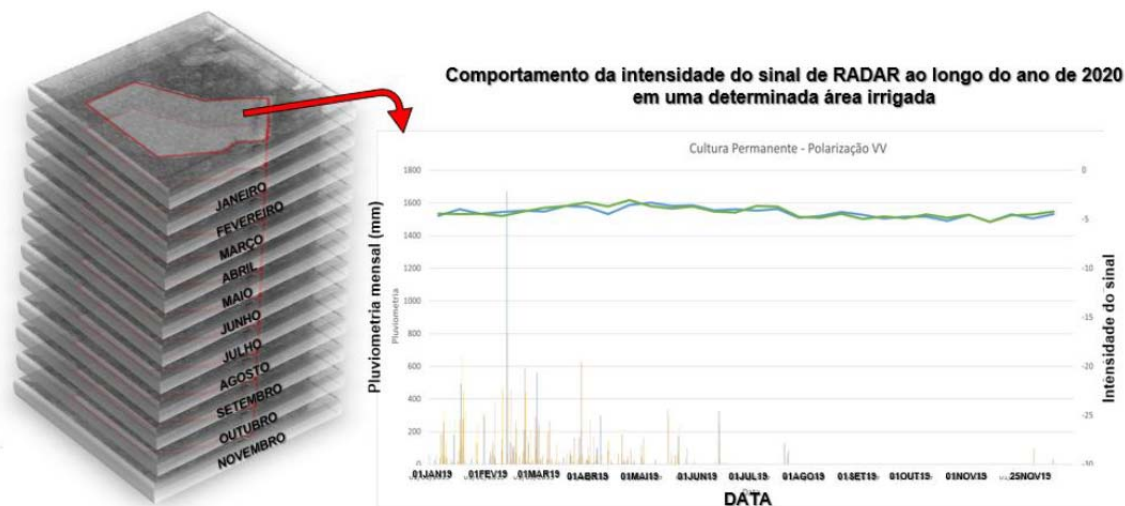
Figura 3.8 - Cultura irrigada permanente identificada a partir de uma análise de uma série temporal das imagens de RADAR geradas entre os meses de janeiro a novembro de 2020
