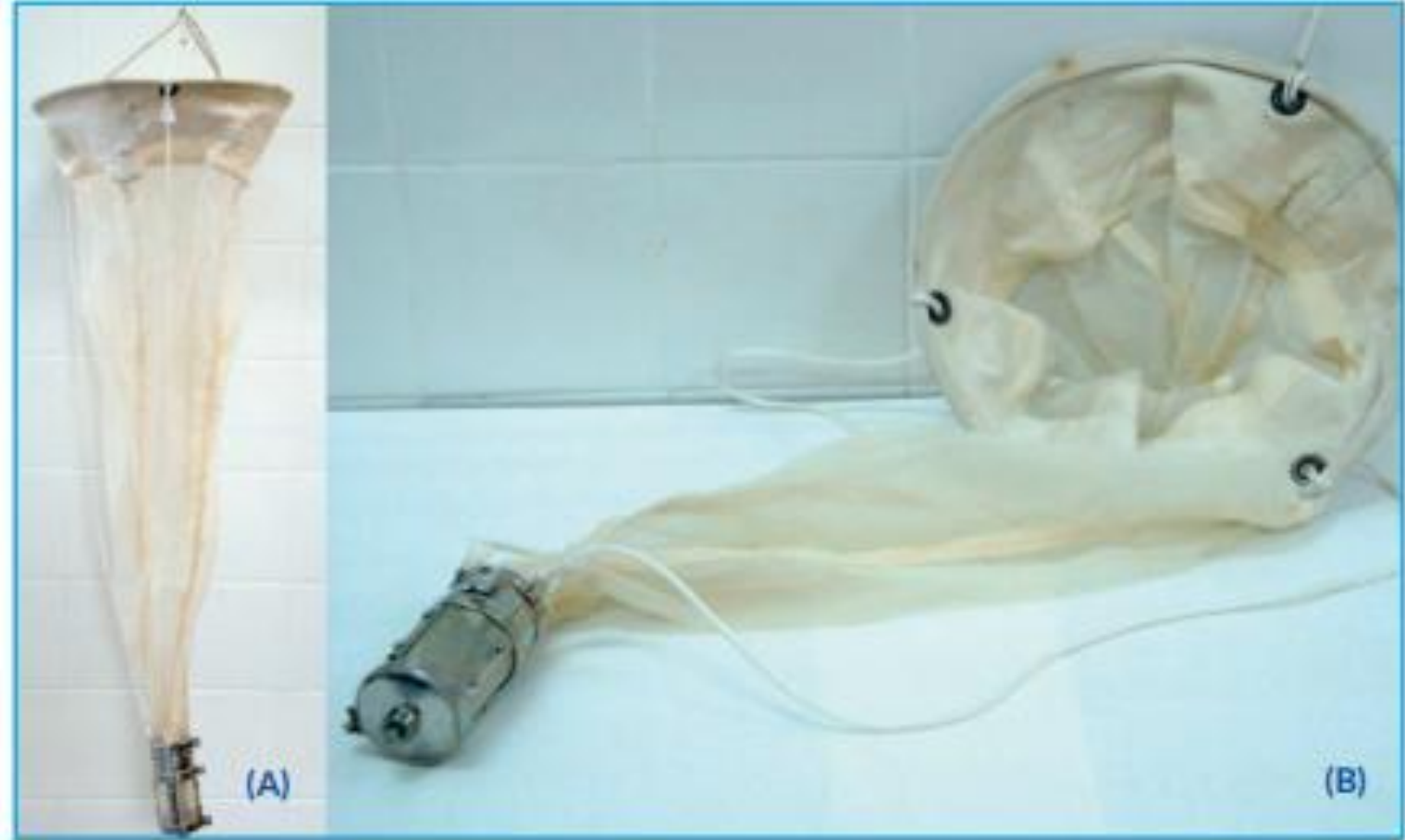
Figura 18. Rede de plâncton: (A) Vista frontal da rede e copo coletor; (B) Vista lateral da rede e copo coletor (Fotos: Carlos Jesus Brandão /CETESB).
