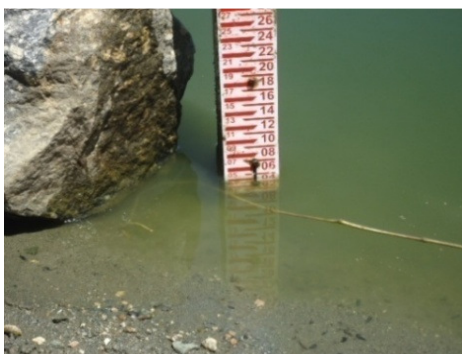
Aferição da cota do açude Serra Vermelha.
