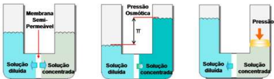
Figura 30 Representação do processo de osmose e osmose inversa (Kerr & McHale 2001).
