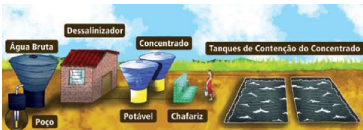
Figura 35 Sistema de dessalinização adotado pelo Programa Água Doce
