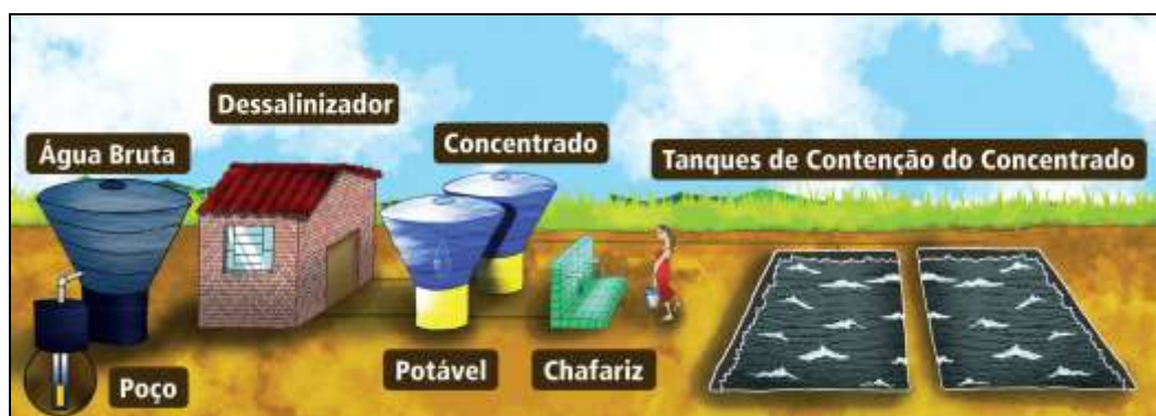
Figura 10 Representação esquemática do sistema de dessalinização adotado pelo Programa
