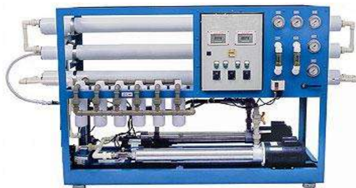
Figura 36 Fotografia de um dessalinizador de 9 membranas
