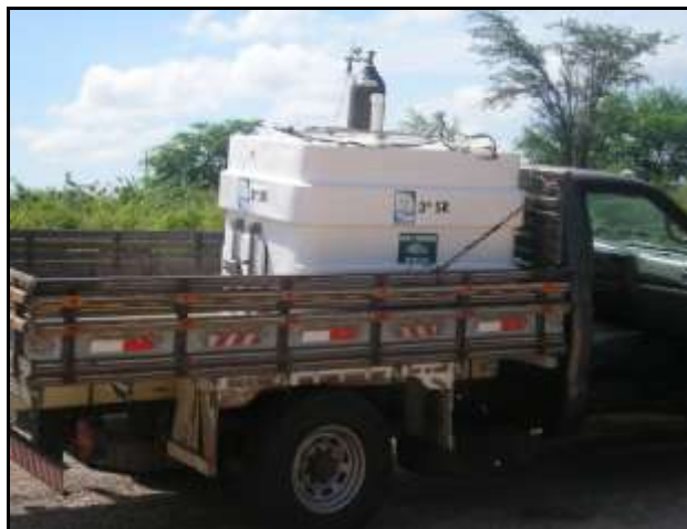
Foto 47 Caixa de transporte de peixes. Características: isolamento térmico; acoplada ao cilindro de oxigênio e capacidade de 400 a 2000 litros.
