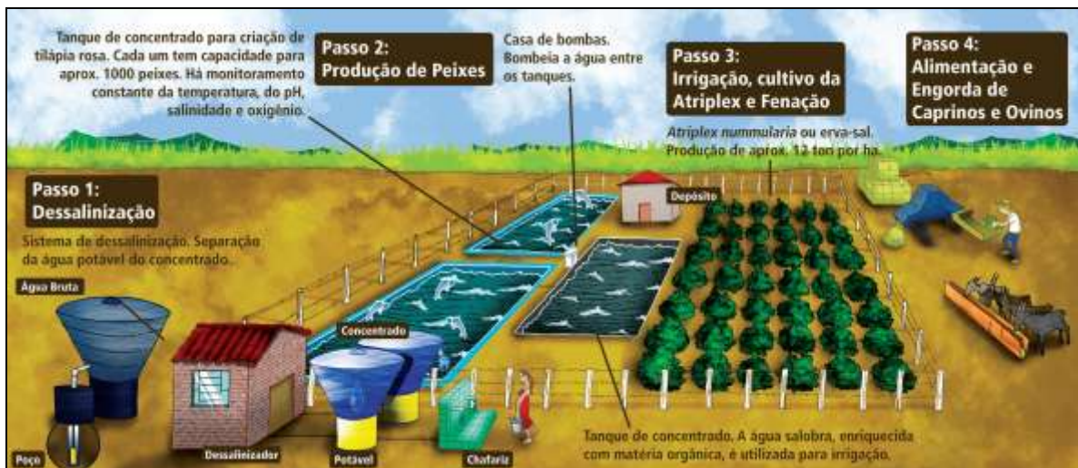
Figura 13 Desenho esquemático do sistema de produção integrado do Programa Água Doce
