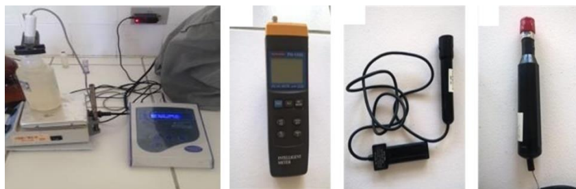
Figura 3 – Equipamentos utilizados nas análises: pHmetro de bancada (A) Medidor multiparâmetro Instrutherm PH 1500 (B), sonda de oxigênio com sensor de temperatura incorporado (B) e sonda de condutividade (C)
