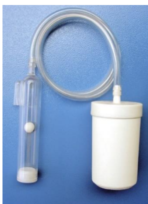
Figura 1- Sensor alternativo de umidade do solo
