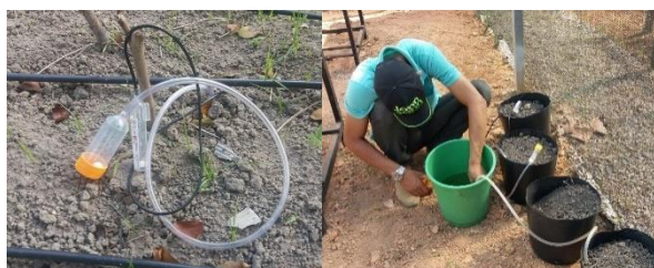
Figura 2- Locais de instalação dos medidores de umidade
