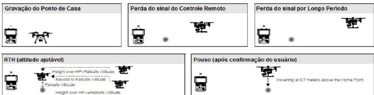
Se o Ponto de Casa foi gravado com sucesso e a bússola está funcionando normalmente, a função Failsafe RTH será automaticamente ativada se perder o sinal do controle remoto por mais de 3 segundos.
