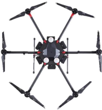
A principal vantagem do multirotor é que ele mantém a capacidade de decolagem vertical e de voo pairado (estacionário/hover) de um helicóptero, mas com a simplicidade mecânica de um avião. O uso de múltiplos rotores elimina a necessidade de um mecanismo de rotor complexo encontrado em um helicóptero.
