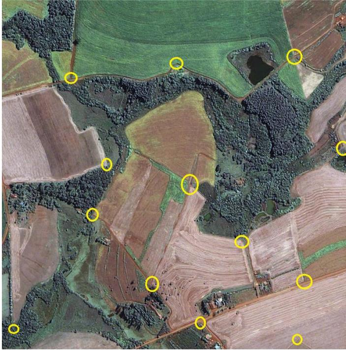
São pontos foto identificáveis, ou seja, são objetos, alvos, detalhes no terreno e que irão aparecer nas imagens aéreas, são utilizados para fazer a relação entre o sistema de coordenadas da imagem com o sistema de coordenadas do terreno, basicamente são pontos de referência no solo que são utilizados no processamento das imagens aumentando assim a qualidade dos produtos finais gerados.
