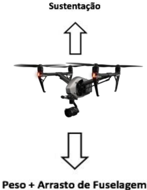
O voo pairado é o tipo de voo no qual o multirotor se encontra imóvel em relação a um ponto. Também, diz-se que o multirotor em voo pairado está “hoverando”. O voo pairado é aquele em que a aeronave está em repouso em relação à massa de ar, ou seja, a velocidade do vento em relação ao multirotor é nula.
