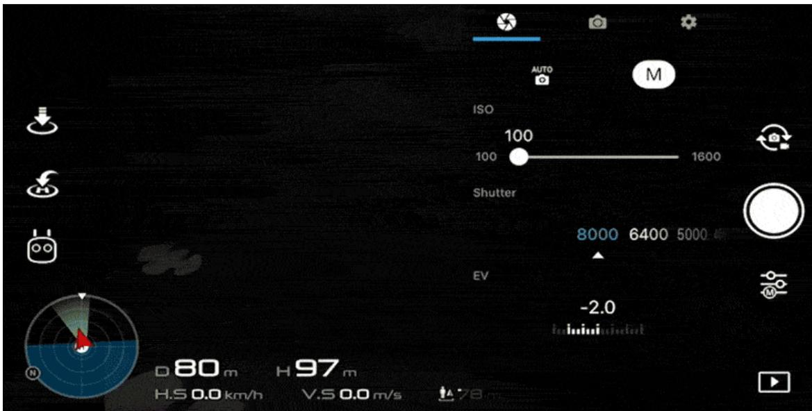
Mas esteja ciente de que você não pode alterar o EV no Modo Manual, pois a compensação de exposição é obtida ajustando o ISO ou a velocidade do obturador.
