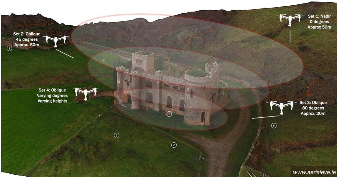
Ao voar no modo Perimeter 3D, o drone capturará imagens a 65 graus para baixo, olhando para o centróide da área do mapa. Quando o modo 3D aprimorado está ativado, o modo 3D do perímetro e o modo Crosshatch são combinados para criar o tipo de modelo de voo exibido abaixo.
