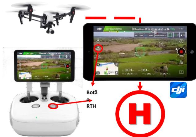
Enquanto o drone retorna, ele irá usar a câmera primária para identificar os obstáculos até 300 metros à frente, permitindo planejar uma rota segura para casa. Mantenha a tecla Smart RTH pressionada uma vez para iniciar o processo, e pressione novamente a tecla Smart RTH para encerrar o procedimento e retomar o controle total do drone.
